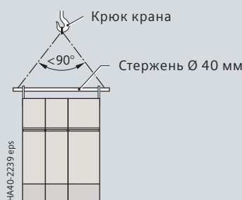
Транспортировка краном с помощью стержня
