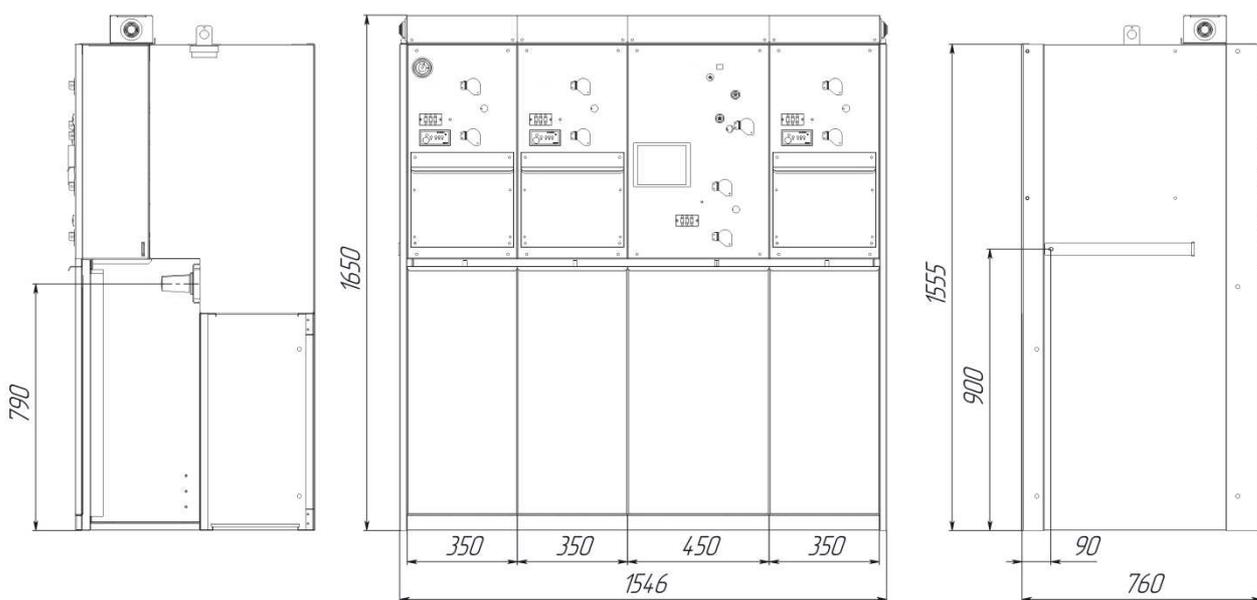
Рисунок 2. Фронтальный вид и вид сбоку моноблока на 4 присоединения, с указанием основных габаритных размеров
