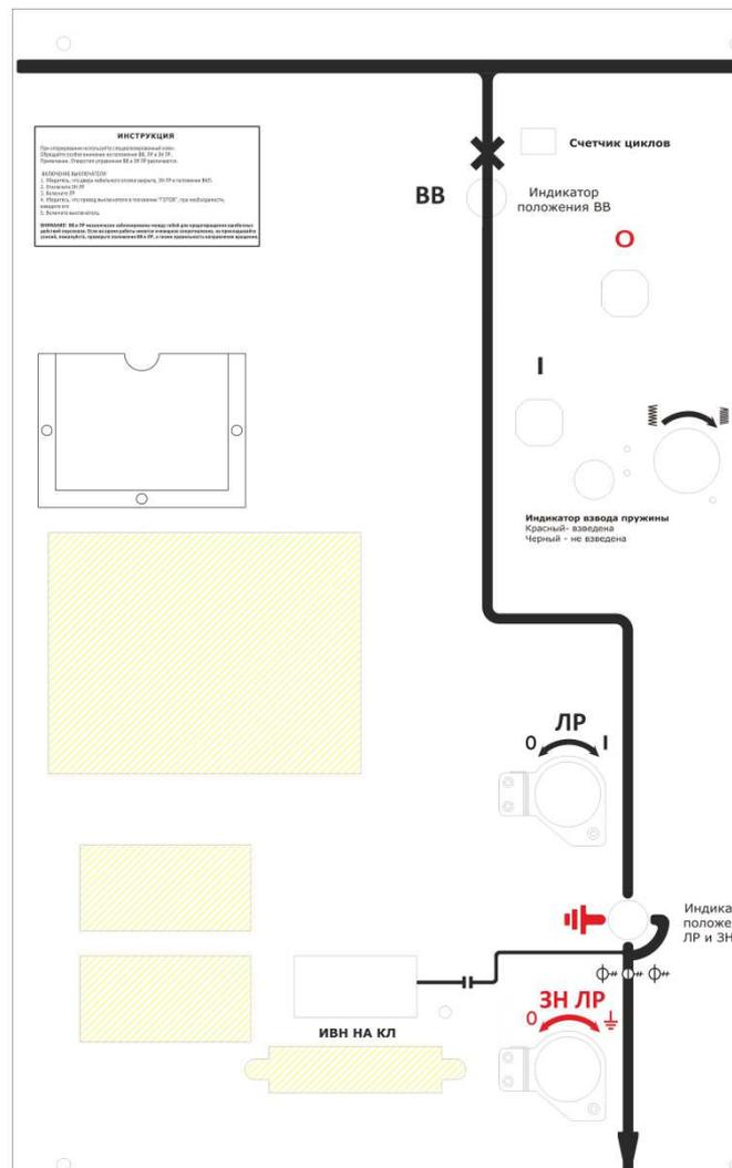
Рисунок 14. Пример выполнения надписей для ячейки присоединения трансформатора
