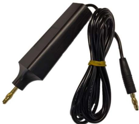
Рисунок 29. Фазовый компаратор
