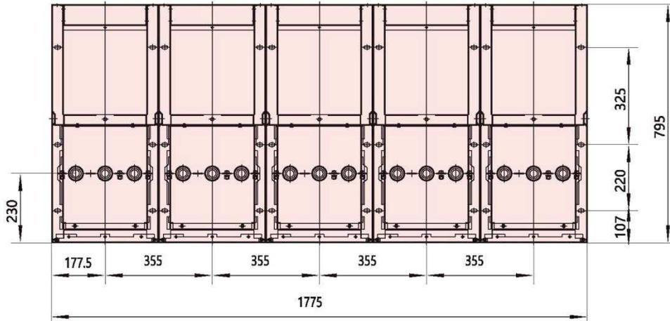
Чертеж с размерами основания блочного модуля (тыльная сторона) NG7-40.5
