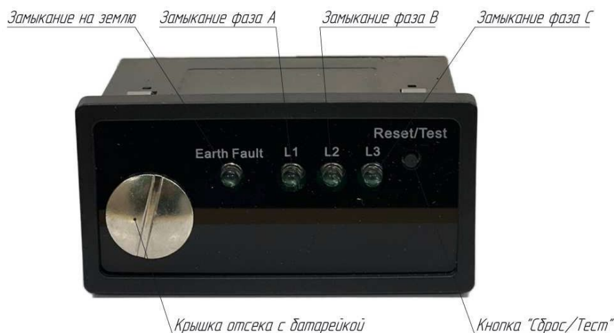
Рисунок 33. Индикаторный блок УТКЗ (вид спереди)
