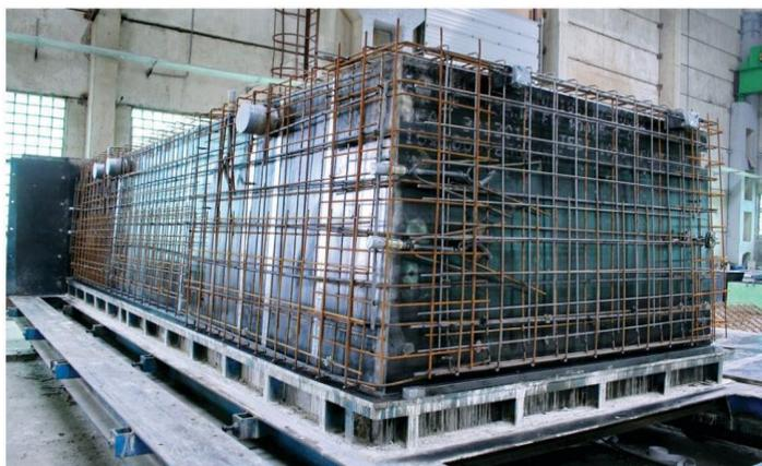
В фундаментной чаше ВН (отсек БКТПБ для высокого напряжения) устанавливаются трубы. По требованию заказчика, также могут быть установлены герметичные вводы для кабелей HSI (или аналоги) для прокладки кабелей высокого напряжения. За счет применения данных вводов достигается стопроцентная герметизация кабельного ввода от попадания влаги в фундаментную чашу.
