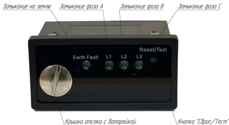
Рисунок 33. Индикаторный блок УТКЗ (вид спереди)
