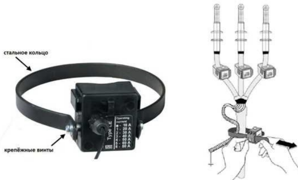
Рисунок 36. Установка датчика типа SE
