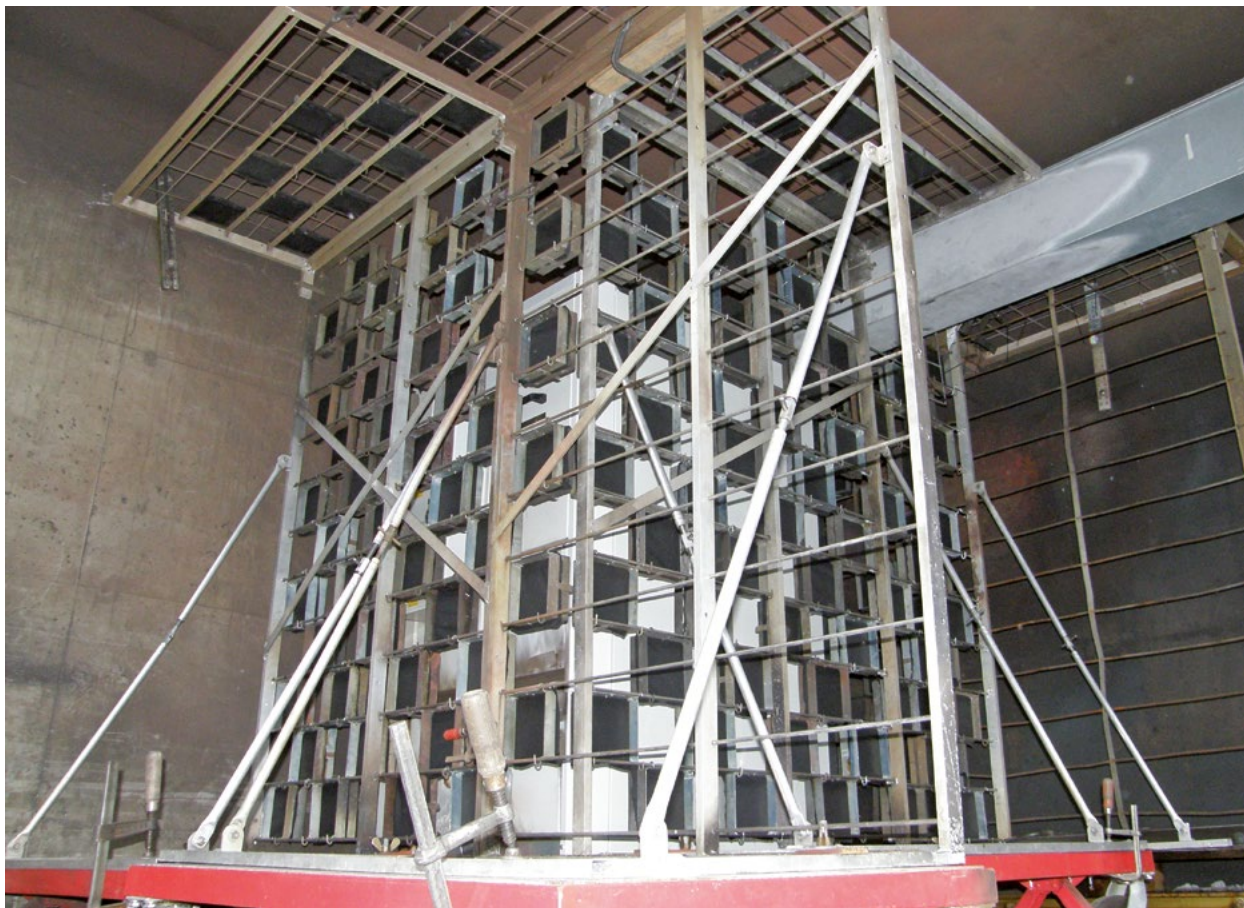
— Установка для испытания прочности на пробой от внутренней дуги
