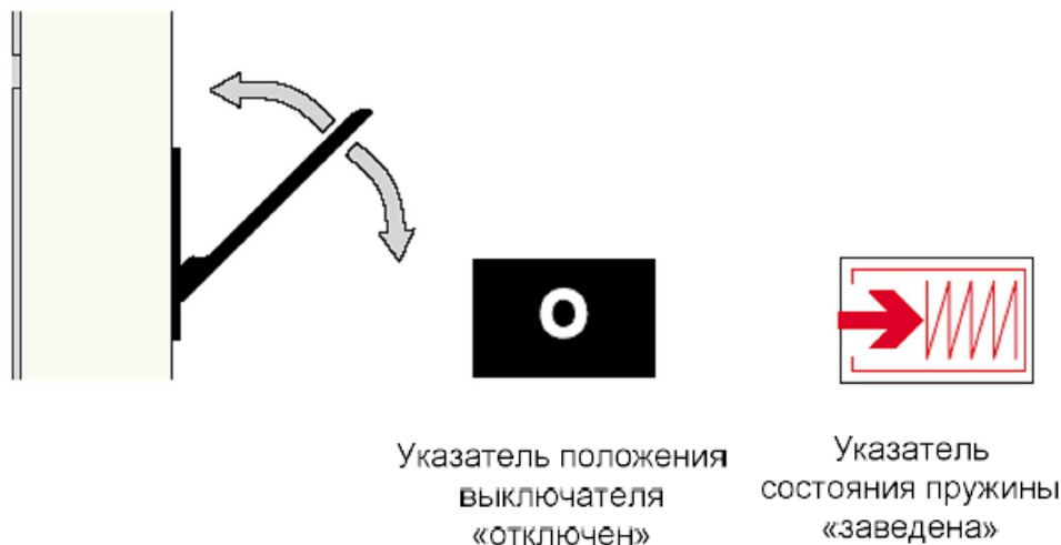
Рисунок 1.2.9 – Исходное положение выключателя
