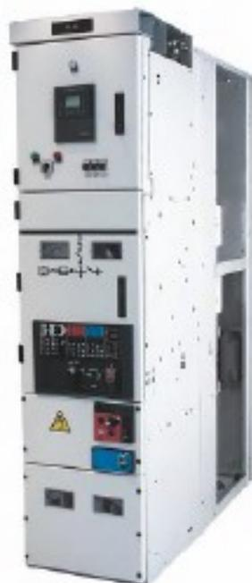
Ячейка MCset для внутренней установки это КРУ в металлическом корпусе со степенью защиты IP-31, разделенном на отсеки металлическими заземленными перегородками. Предназначено для распределения электроэнергии среднего напряжения на ВВ/СН подстанциях и на СН/НН подстанциях большой мощности.
