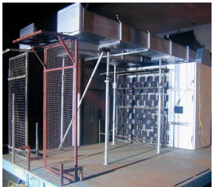
Рисунок 2. UniGear ZS1 во время испытания на стойкость к внутренней дуге
