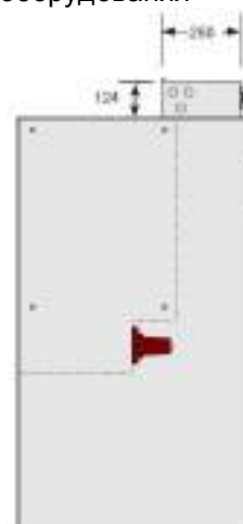
Дополнительный отсек низковольтного оборудования (вид сбоку)
