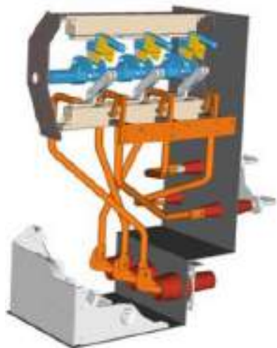
Рис. 15. Присоединение С с втулками для испытания кабелей.
