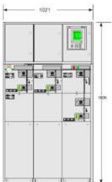
Отсек низковольтного оборудования с REF541
